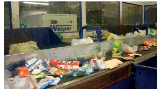
Cabine de tri des emballages recyclables
